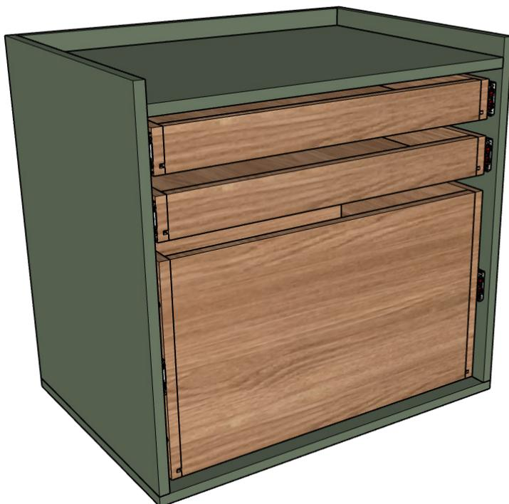
7. Instale as frentes das gavetas, fixando-as com parafusos de 4,5mm x 25mm pela parte interna da gaveta. O espaçamento entre gavetas para este projeto é de 3mm; você pode utilizar uma pequena ripa de madeira para auxiliar nesse espaçamento.
